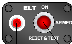
Fernbedienschalter RC 200 im Cockpit (in der Mittelkonsole, unter dem Autopiloten)
